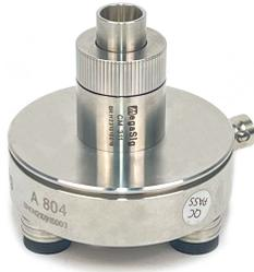
压力场人工耳是模拟耳塞导管插入耳道或耳廓方式的耳模拟器，模拟耳机与人耳耦合从而测量耳机的声学性能。
